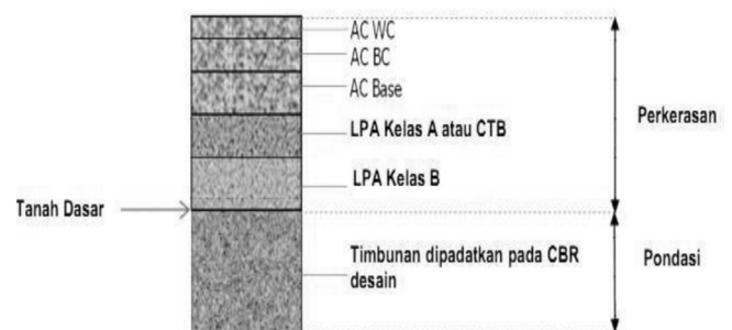
Gambar 2. Struktur Perkerasan Lentur (Lalu Lintas Berat) pada Tanah Timbunan
