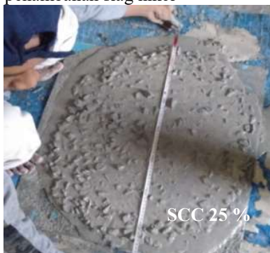
Gambar 3. gambar menunjukkan hasil slump flow pada variasi 25 % penambahan slag nikel
