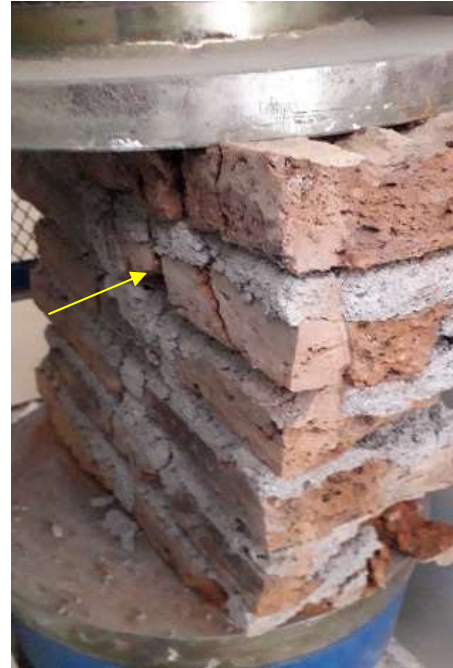
Gambar 4. Retakan batu bata uji 0^\circ
