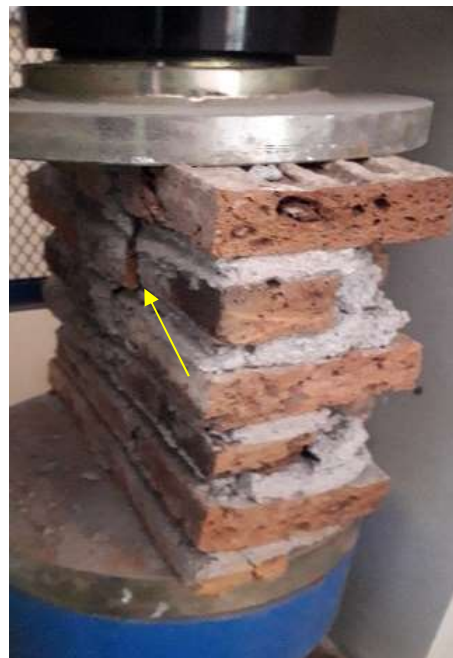
Gambar 5. Retakan batu bata uji 0^\circ
