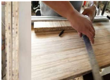
Gambar 1. Papan laminasi bamboo dengan dua arah sumbu utama: sejajar serat dan tegak lurus serat
