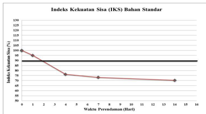
Gambar 3.1 Hubungan antara Indeks Kekuatan Sisa (IKS) Bahan Standar dengan Waktu Perendaman
