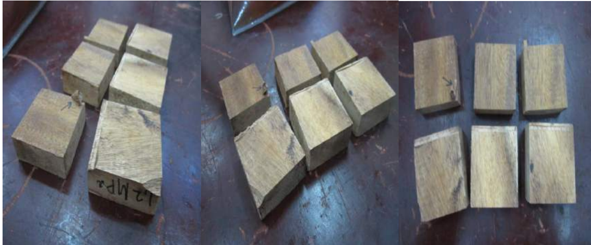
Gambar 8. Model Kerusakan Blok Geser Laminasi
