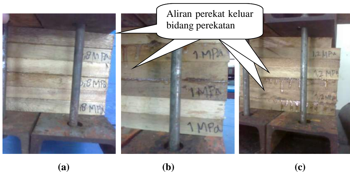
Gambar 7. Besar Tekanan Perekatan 0,8 MPa (a); 1, MPa (b); 1,2 MPa (c)
