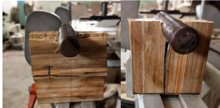
Gambar 4. Kerusakan yang terjadi pada benda uji kuat tumpu papan laminasi bambu
