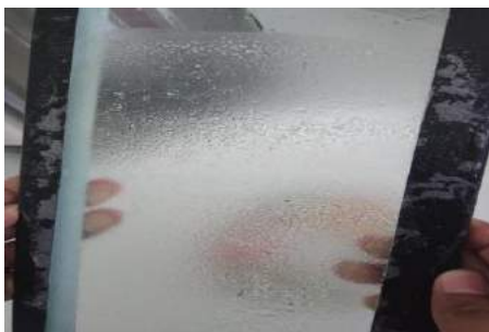
Gambar 4. Membran selulosa asetat (SA) dari kulit kakao ( Theobroma cacao L. )
