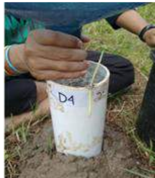
Gambar 5. Pengukuran konduktivitas hidrolis jenuh
