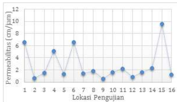
Gambar 8. Permeabilitas tanah di 16 titik
