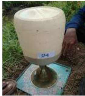
Gambar 3. Penentuan kepadatan tanah dengan sandcone
