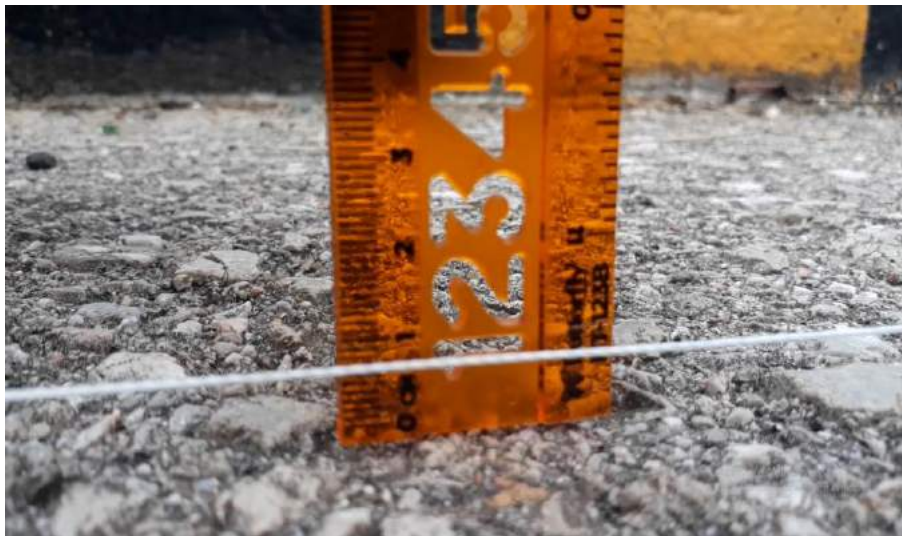
Gambar 5: Hasil lendutan jembatan Sungai Dareh Dharmasraya dengan peninjauan langsung dilapangan
