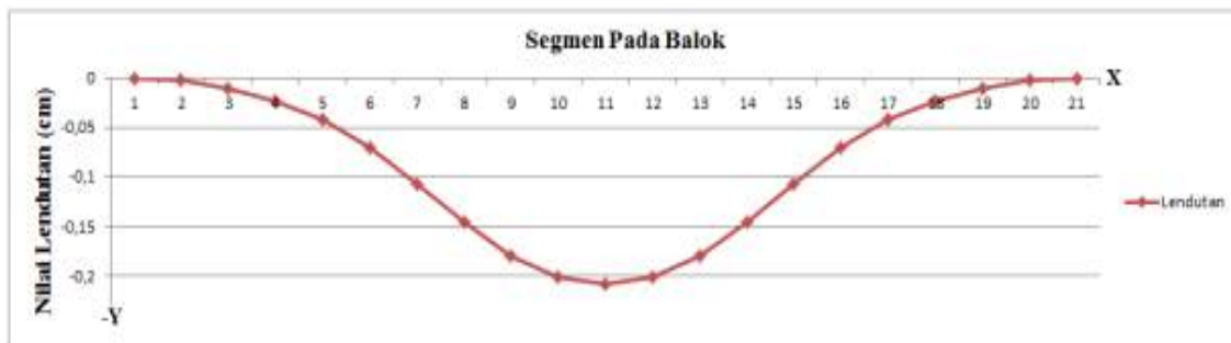
Gambar 5. Lenturan yang terjadi pada balok rencana
